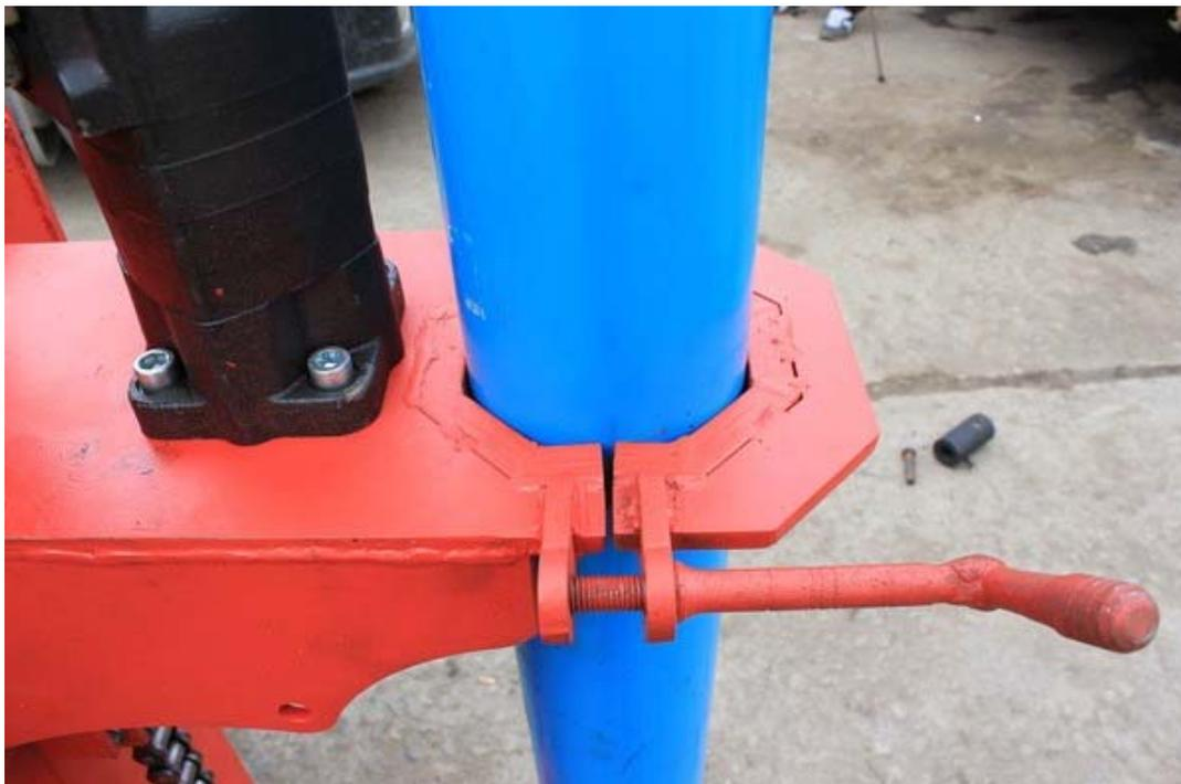
Съемный крепеж для обсадной трубы – изобретение, которое способно значительно упростить обсадку скважины. Ходовая каретка представляет собой универсальное техническое решение, которое делает операции спуска и подъема гораздо удобнее. Такая конструкция отлично подойдет для быстрой и эффективной обсадки скважины.
