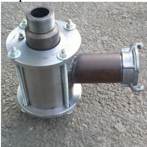
Для эффективной и стабильной подачи бурового раствора в место бурения необходим вертлюг. Эта герметичная конструкция необходима для снижения трения при вращении вала. Вертлюги от компании «Бурагрегат» укомплектованы высококачественными подшипниками, что позитивно сказывается на долговечности конструкций. Кроме того, агрегаты могут похвастаться простой схемой подачи смазочного материала на вал, что повышает эффективность работы всей системы.
